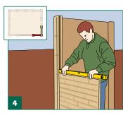
Jetzt wird, wie in Abb. 2 und 3, über Eck gebaut. Dabei muss der **Rechte Winkel** eingemessen werden und die Platten genau **in Waage** liegen. Dieses **immer überprüfen!** An der Vorderseite sollten zuerst nur die Unterplatten montiert werden.
