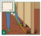
Zuerst sollten die Seitenwände und Rückwände komplett fertig gebaut werden, jedoch müssen die beiden vorderen Pfosten beweglich bleiben. Sie werden noch nicht einbetoniert, um Maßtoleranzen mittels Hebelwerkzeug an der Vorderseite ausgleichen zu können.
