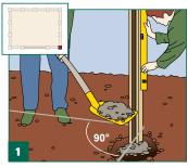
Legen Sie den Ausgangspunkt für den ersten Eckpfosten der Vorderseite fest. Für das Einbringen des Fundamentes zum Setzen des Eckpfostens wird das erste Erdloch nach statischer Vorgabe ausgehoben. Damit wird eine frostfreie Gründung garantiert. Der Eckpfosten wird einbetoniert (Kies, Sand-Zement-Gemisch – Betongüte C 16/20 - erdfeucht). Dabei ist besonders auf lotgenaues Ausrichten des Eckpfostens zu achten.
