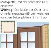
Danach setzen Sie die Türe passgenau in die Nut des ersten vorderen Zwischenpfostens – genau das gleiche Prinzip wie bei den Betonwänden. Das Ende der Türe mit einem Pflasterstein unterlegen und den zweiten vorderen Zwischenpfosten passgenau an der Türe einbetonieren.
