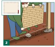
Die untere Motivplatte (mit der breiten Nut) wird nun nach eingemessener Flucht (Richt-schnur) in die Nut des Eckpfostens eingesetzt. Das Ende der Platte **mit einem Pflasterstein unterlegen**, so dass die Platte genau **in Waage** ist und fest aufliegt. Dann obere Motivplatte (mit der schmalen Nut) einsetzen
