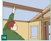
Im Anschluss werden die schon auf Maß geschnittenen Sparren in die vorhandene Nut gelegt und die passgenauen **USB-Platten**, mit der Schriftseite nach oben, auf die Dachkonstruktion geschraubt.
