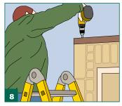
Bevor Sie mit den Holzarbeiten beginnen, muss der **Ringbalken** auf entsprechende Länge gekürzt und dann auf die vorhandenen Betonpfosten verschraubt werden. Zur Stabilisierung wird in den Ecken ein Winkel verschraubt. Die Türe wird nun angehoben und von unten an den Ringanker geschraubt.
